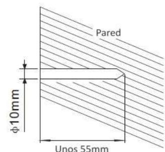
Inserte los pernos de anclaje en los orificios perforados, y coloque las clavijas completamente dentro de los pernos de anclaje con un martillo.
