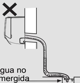
• Incline la manguera de drenaje ligeramente hacia abajo. La manguera de drenaje no puede estar curvada, elevada ni ondulada, etc.
