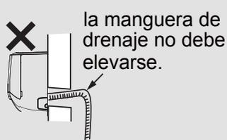
• La salida de agua no debe sumergirse en agua, con el fin de drenar sin problemas.
