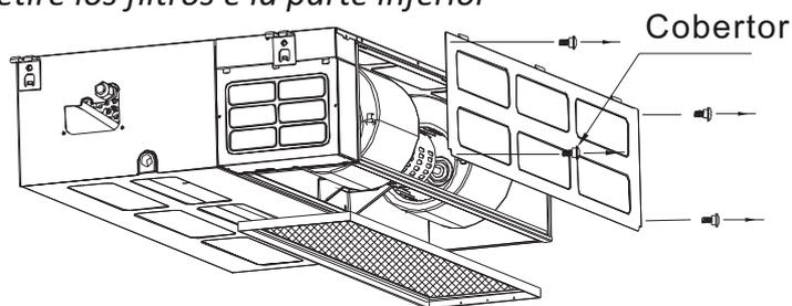
3. Coloque la tapa posterior en la parte inferior de la unidad, donde estaban colocados los filtros
