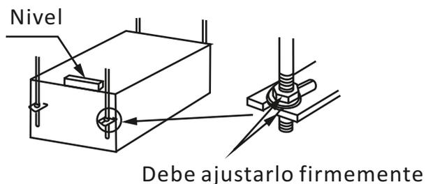
Coloque la varilla roscada con la arandela y la tuerca, dentro del soporte U de la unidad
