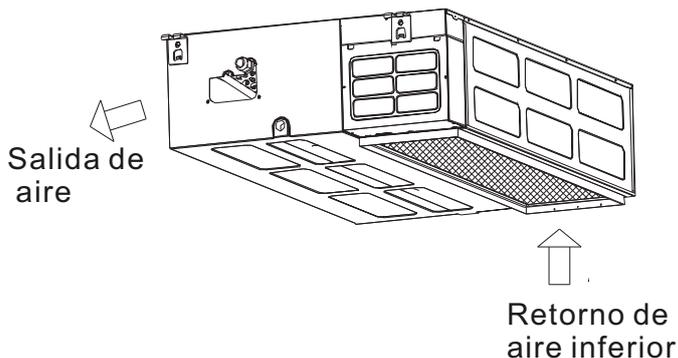
2. Afloje la tuerca y desmonte la tapa posterior. Luego retire los filtros e la parte inferior
